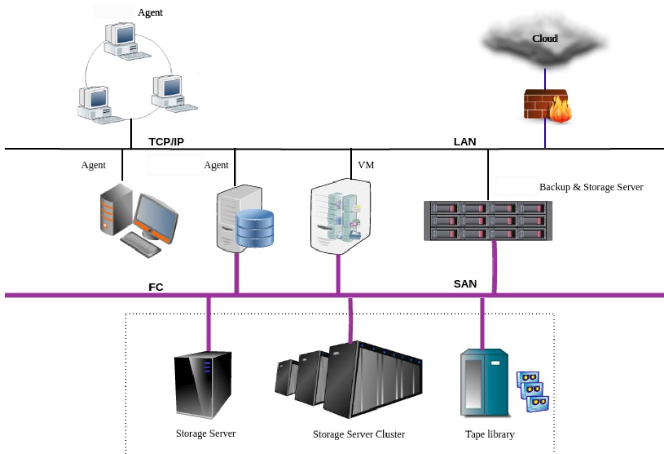
若需实现异地容灾，用户可在远程数据中心部署一个二级存储服务器，通过在页面进行存储池的复制配置，将形成本地数据库服务器、一级存储服务器、二级存储服务器的多级存储架构。
